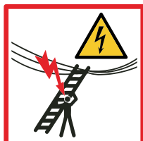
Advertencia, peligro de electricidad. Identifique cualquier riesgo eléctrico en la zona de trabajo, como líneas aéreas u otros equipos eléctricos expuestos, y no utilice la escalera donde existan riesgos eléctricos.
