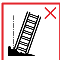
No utilice la escalera sobre una base desnivelada o poco firme.
