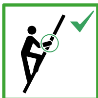
Sujete bien la escalera al subir y bajar. Mantenga un agarre mientras trabaja desde una escalera o tome precauciones de seguridad adicionales si no puede hacerlo.
